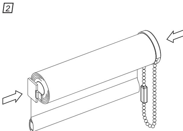
2 Stecken Sie die Montageadapter auf Bedien- und Montageprofil auf.
