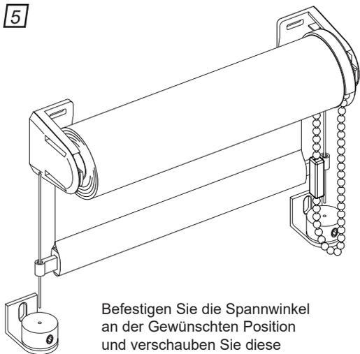
Befestigen Sie die Spannwinkel an der gewünschten Position und verschrauben Sie diese mit passenden Schrauben und Dübeln an der Wand.
