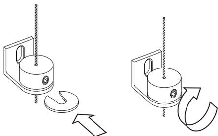
Schieben Sie den Sicherungsring zwischen Wandwinkel und Drahtspanner ein.
