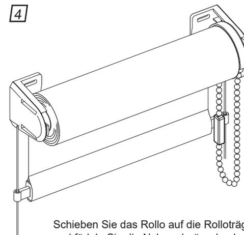
4 Schieben Sie das Rollo auf die Rolloträger auf und fädeln Sie die Nylonschnüre durch die Spanndrahtgleiter.
