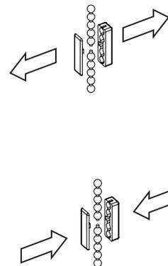
Lösen Sie zum Kürzen den Kettenverbinder von der Kette. Kürzen Sie sie wie gewünscht und fügen Sie sie mit dem Kettenverbinder wieder zusammen.
