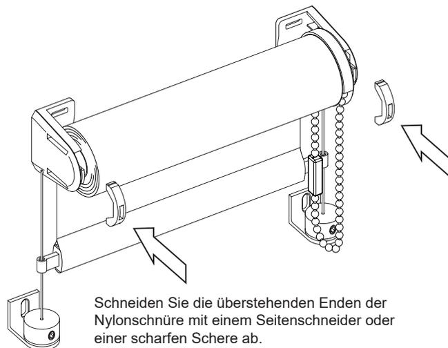
Schneiden Sie die überstehenden Enden der Nylonschnüre mit einem Seitenschneider oder einer scharfen Schere ab.
