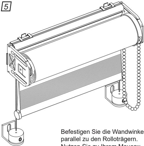
Befestigen Sie die Wandwinkel parallel zu den Rolloträgern. Nutzen Sie zu Ihrem Mauerwerk passende Schrauben und Dübel.
