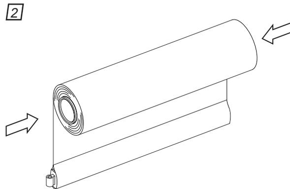
Stecken Sie die Adapterringe in die Rollwelle.
