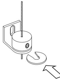
Schieben Sie den Sicherungsring zwischen Wandwinkel und Drahtspanner ein.
