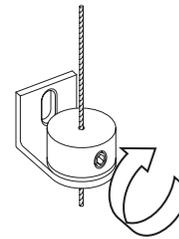
Spannen Sie die Spanndrähte und arretieren Sie sie mit der Stellschraube.
