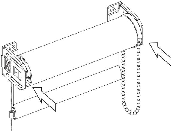
Schieben Sie das Rollo auf die Rolloträger auf und fädeln Sie die Spanndrähte durch die Spanndrahtleiter.
