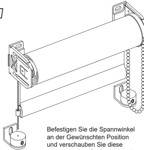
Befestigen Sie die Spannwinkel an der gewünschten Position und verschrauben Sie diese mit passenden Schrauben und Dübeln an der Wand.
