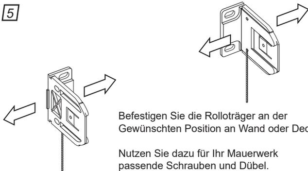
Befestigen Sie die Rolloträger an der gewünschten Position an Wand oder Decke.
